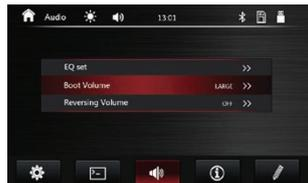
Настройки эквалайзера и баланса, уровня громкости при включении, уровня приглушения звука при включении задней передачи.
